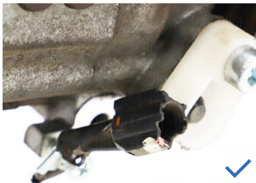
Stecker ohne Beschädigung
