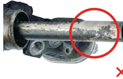
Abgenutzte oder beschädigte Gewinde, Ritzel, Keilnuten oder Anschlüsse und Dichtflächen
