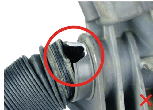
Demontiertes / unvollständiges Teil
